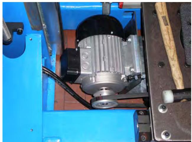
**HYDRAULIC PUMP MOTOR M4**
