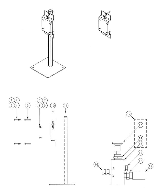
FIGURE 9. WALL / STAND POWERPACK MOUNTING
